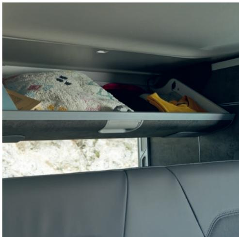
**Dachstaukasten.** Oberhalb der Sitzbank-Rückenlehne ist ein abklappbarer Staukasten angebracht. Er fasst ca. 45 l und kann auch im Sitzen und im Liegen geöffnet werden.
