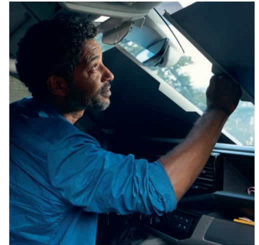
**Verdunkelung im Cockpit.** Die Frontscheibe wird mit zwei Rollos, das Fahrer- und das Beifahrerfenster jeweils mit einer Magnetgardine verdunkelt.
