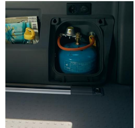
**Gasfach.\*** Unter der hermetisch verschliessbaren Abdeckung kann eine optional erhältliche 1,8-kg-Campinggas-Gasflasche an Laschen sicher befestigt und mit dem Gasschlauch verbunden werden.
