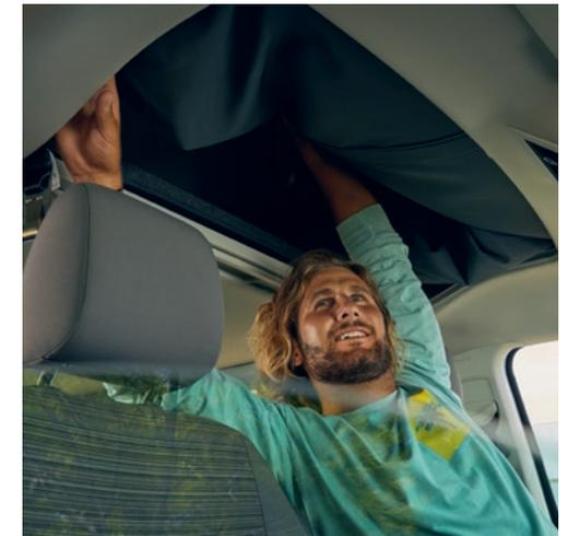
**Manuelles Aufstelldach.** Es lässt sich an der Aufstiegsöffnung leicht entriegeln und nach oben drücken. Auf Wunsch ist der California Beach erstmals auch mit elektrohydraulischem Aufstelldach inklusive Frontöffnung<sup>1)</sup> erhältlich.
