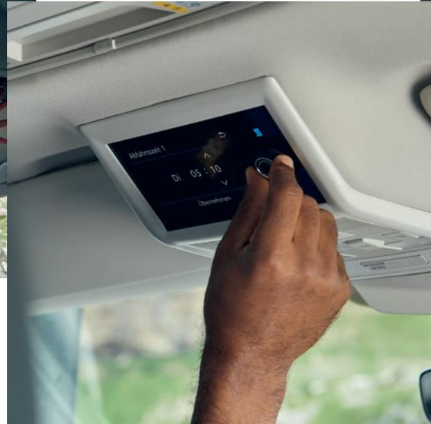
Am neuen Camper Bedienteil kann die Standheizung für die Nacht auf Dauerbetrieb eingestellt werden.
