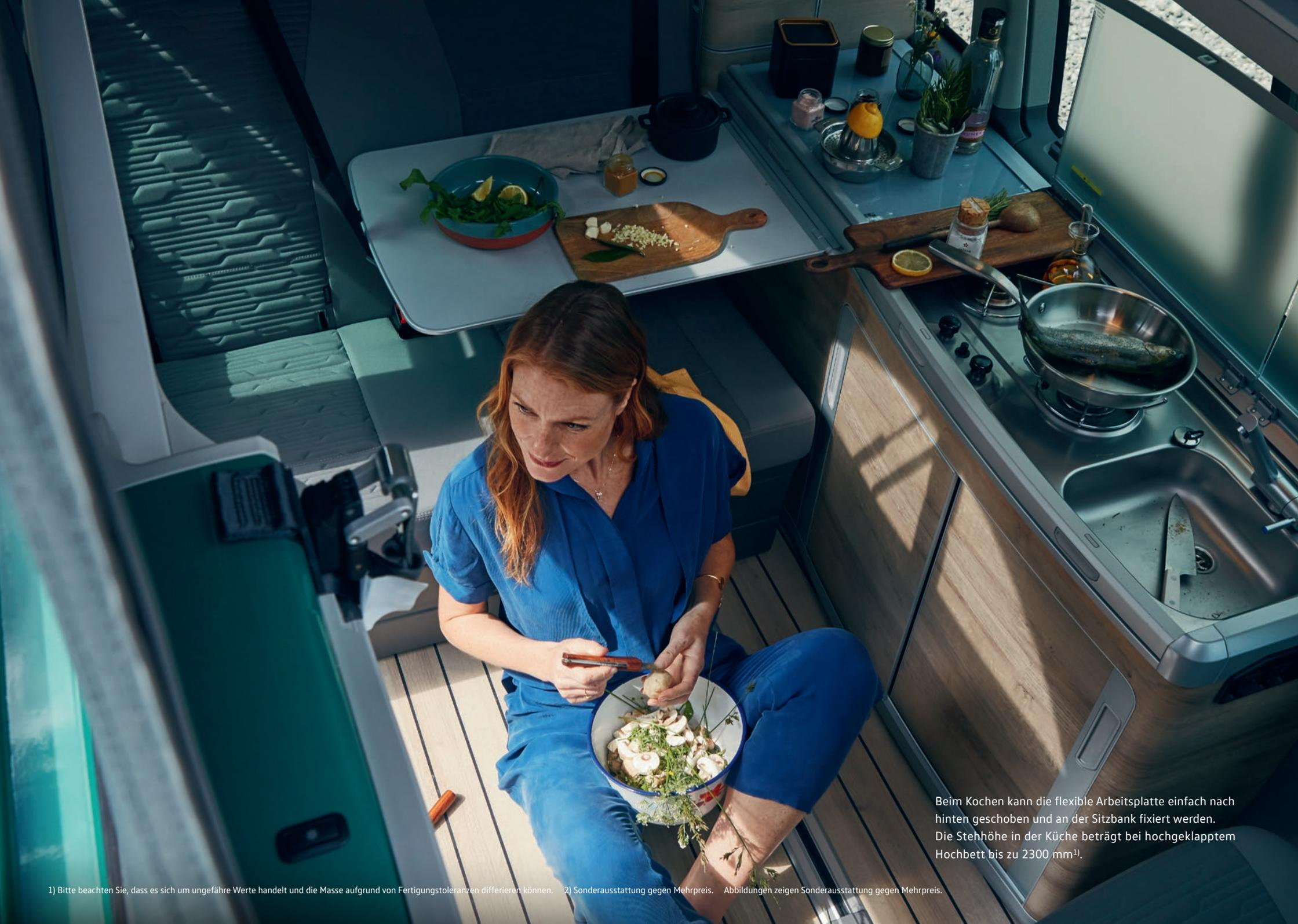
Beim Kochen kann die flexible Arbeitsplatte einfach nach hinten geschoben und an der Sitzbank fixiert werden. Die Stehhöhe in der Küche beträgt bei hochgeklapptem Hochbett bis zu 2300 mm<sup>1)</sup>.
